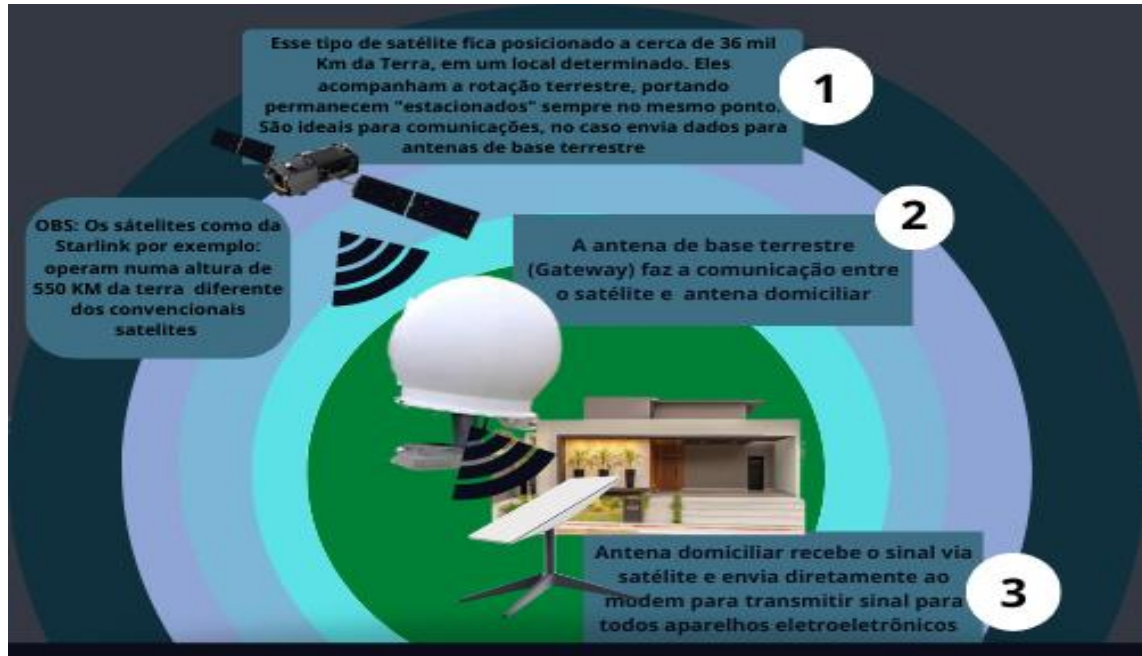
Figura 6. Funcionamento do equipamento via satélite Starlink .
